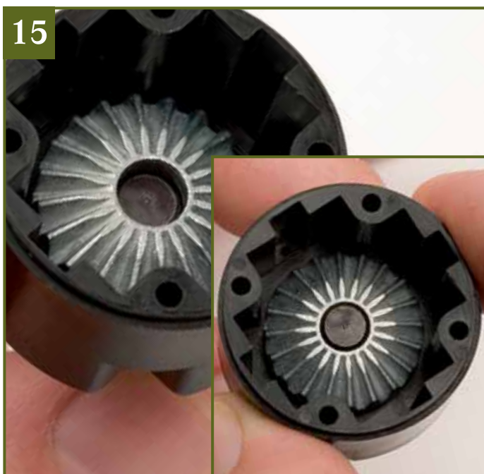
15 Halten Sie das Gehäuse aufrecht, und legen Sie das Achskegelrad so ein, dass sich die Achswelle durch die zentrale Bohrung im Kegelrad schiebt (großes Bild). Drehen Sie an der Achswelle, bis der Mitnehmerstift einrastet. Das Kegelrad muss dabei ganz auf die Welle rutschen (kleines Bild).
