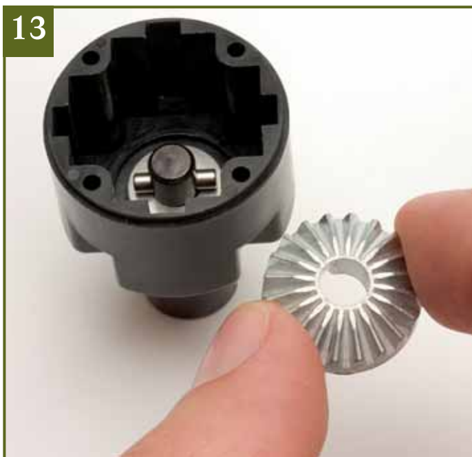
13 Hauptaufgabe des Mitnehmerstifts ist es, die Drehbewegung der Achswelle auf das Achskegelrad zu übertragen. Letzteres setzen Sie nun ins Differenzialgehäuse ein. Die konisch zulaufende, gezahnte Seite zeigt dabei nach oben.
