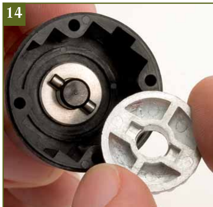
14 An der Unterseite weist das Achskegelrad eine schlitzförmige Aussparung auf, in die der Mitnehmerstift greift. Richten Sie diese in etwa parallel zum Stift im Gehäuse aus. Achten Sie darauf, dass der Mitnehmerstift möglichst gleich weit zu beiden Seiten der Achswelle herausragt und nicht verrutscht.
