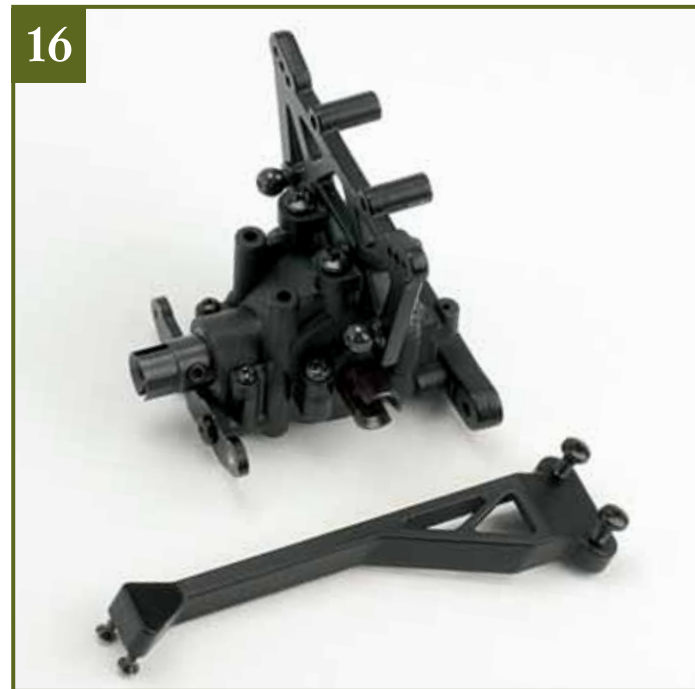
16 Als Ergebnis der heutigen Montagesitzung liegen Ihnen eine fest auf der Differenzialhalterung verankerte, mit zwei Kugeln bestückte Dämpferbrücke sowie die zur Montage vorbereitete Längsstrebe der Hinterachse vor.
