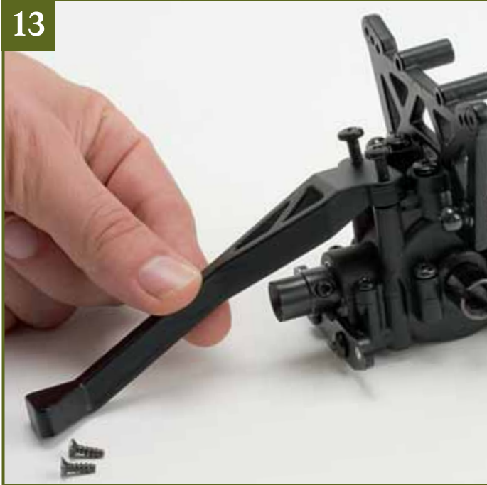
13 Die beiden übrigen Linsenschrauben M4 x 10 mm dienen der Montage der Längsstrebe an der Differenzialhalterung. Sie erfolgt erst beim Verankern der Hinterachse auf dem Chassis und ist hier nur angedeutet.
