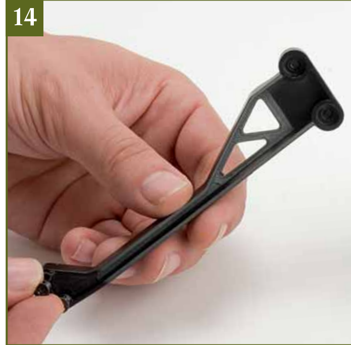
14 Mit den beiden Senkkopfschrauben wird die Längsstrebe später von der Chassisunterseite her befestigt. Die Schraubenköpfe schließen dann bündig mit den angesenkten Bohrungen in der Bodenplatte ab.
