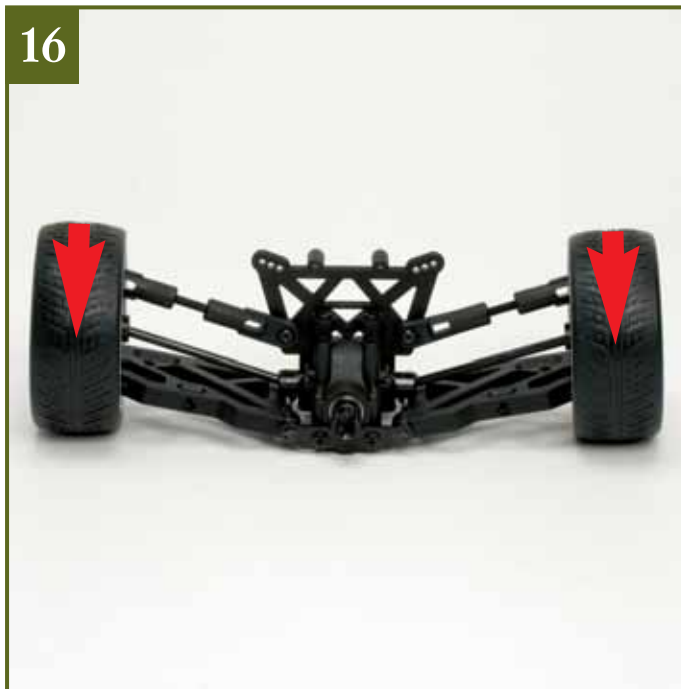
16 Auf die gleiche Weise montieren Sie auch das zweite Rad. Beachten Sie dabei die Laufrichtung des Profils: Die „Pfeilung“ der Rillen muss zur Vorderseite des Fahrzeugs weisen.
