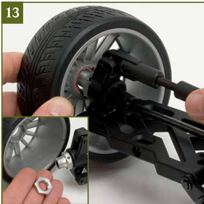
13 Zum Bereifen lösen Sie die Radmutter von der Nabe (kleines Bild). Setzen Sie Felge samt Reifen so an, dass der Sechskant des Radmitnehmers in die sechseckige Aufnahme an der Innenseite der Felge greift.
