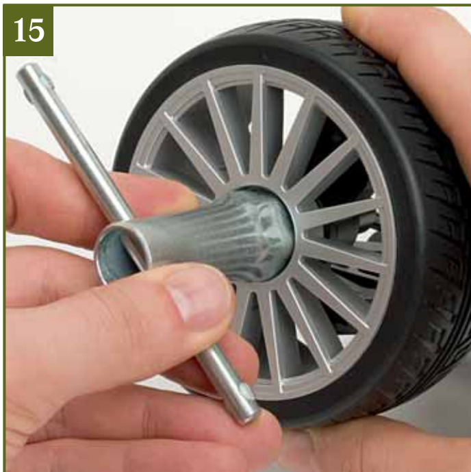
15 Vergewissern Sie sich, dass die Radmutter gerade auf dem Gewinde sitzt und nicht verkantet kann. Mit dem Radmutternschlüssel (Bestandteil von Ausgabe 16) ziehen Sie die Mutter ganz an. Halten Sie dabei das Rad fest.
