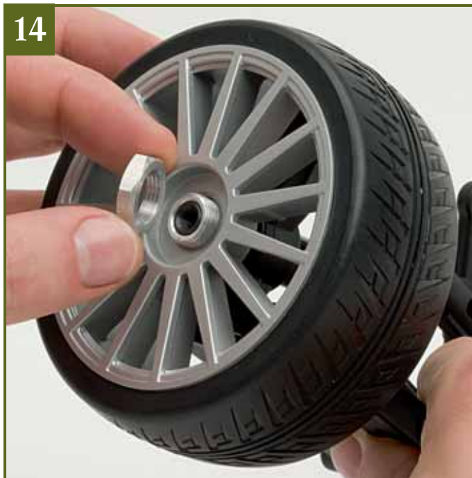
14 Das Rad sitzt richtig, wenn das Außengewinde des Mitnehmers, wie gezeigt, fast vollständig aus dem Zentrum der Felge hervorragt. Setzen Sie die Radmutter so an, dass sie sauber in die erste Windung greift.
