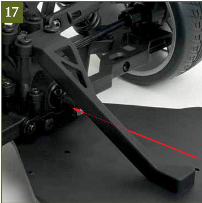
17 Die korrekt eingebaute Längsstrebe spannt sich von der Oberseite der Differentialhalterung zur Bodenplatte und ist dabei seitlich so versetzt, dass sie der Antriebswelle (angedeutet als roter Pfeil) genügend Platz lässt.
