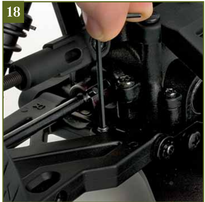
18 Mit dem 2-mm-Inbusschlüssel (Bestandteil von Ausgabe 12) können Sie nun die Madenschrauben in den unteren Querlenkern justieren, die den Ausfederweg der Radaufhängungen begrenzen.
