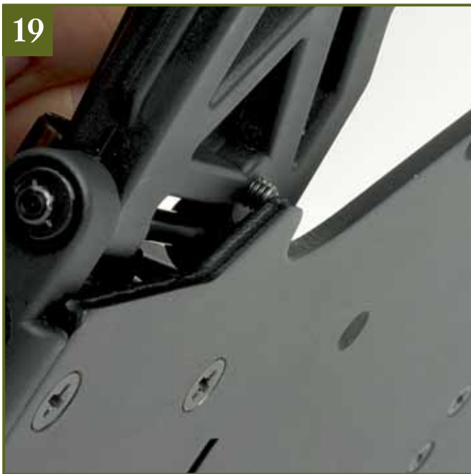
19 Wie im Bild zu sehen ist, dienen die Ausbuchtungen am schmalen Ende der Chassisplatte als Anschlag. Drehen Sie die Madenschrauben auf beiden Seiten so weit hinein, dass sie gerade eben die Platte berühren.
