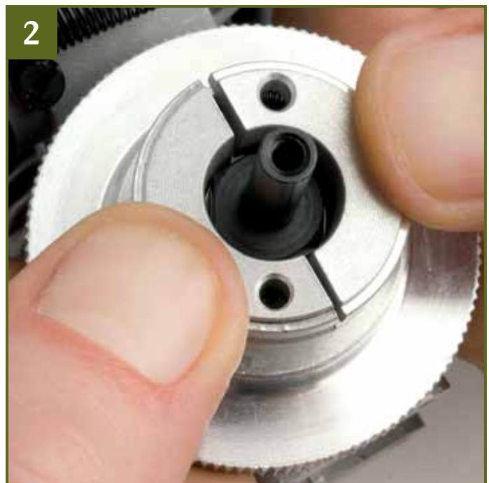
2 Die Kupplungsbacken mit den beiden Bohrungen auf die Lagerstifte der Schwungscheibe stecken und nach unten drücken, bis Sie spüren, dass die Stifte auf den Widerstand der Kupplungsfeder in der Nut stoßen.
