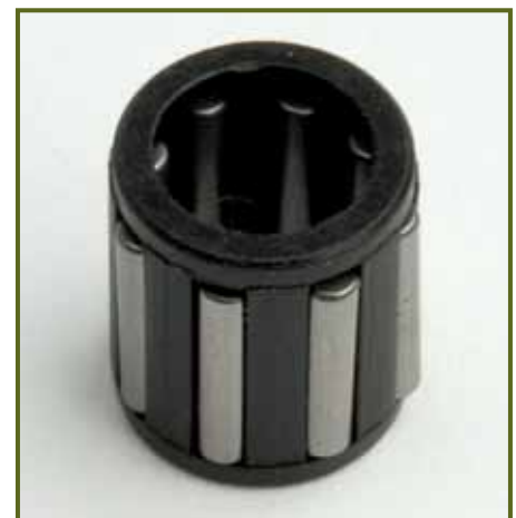
Unten: In der Kunststoffwandung des Lagers sorgen acht Stahlwalzen (Nadeln) für einen möglichst reibungsarmen Lauf der Kurbelwelle. Der Innendurchmesser des Nadellagers beträgt 5 mm.
