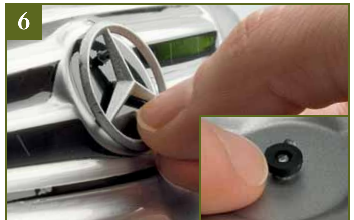
6 Sie nehmen den Stern und stecken die beiden Stifte auf seiner Rückseite in die Bohrungen. Drücken Sie ihn bis zum Anschlag an die Karosserie. Den Stopper (Ausgabe 78) schieben Sie von innen auf den größeren Stift (kl. Bild)
