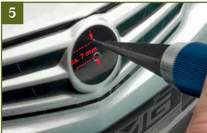
5 Im Zentrum der Fläche für den Mercedes-Stern setzen Sie mithilfe der Reibahle eine 3-mm-Bohrung. Darüber bringen Sie im Abstand von ca. 7 mm eine zweite Bohrung von 2 mm Durchmesser an.
